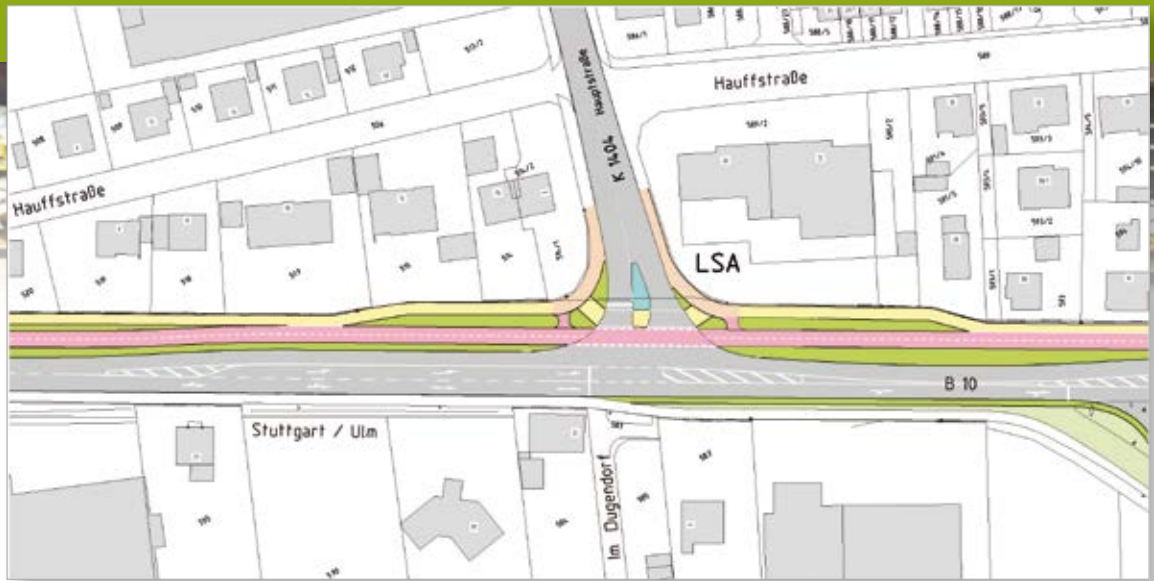
Knotenpunktvarianten – Einmündung Salach.
