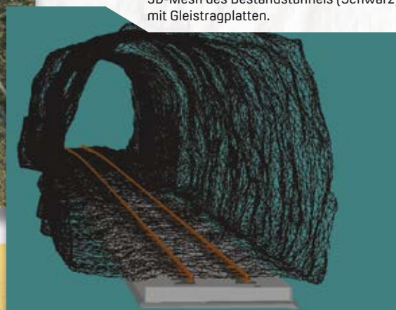
3D-Mesh des Bestandstunnels (Schwarz) mit Gleistragplatten.
