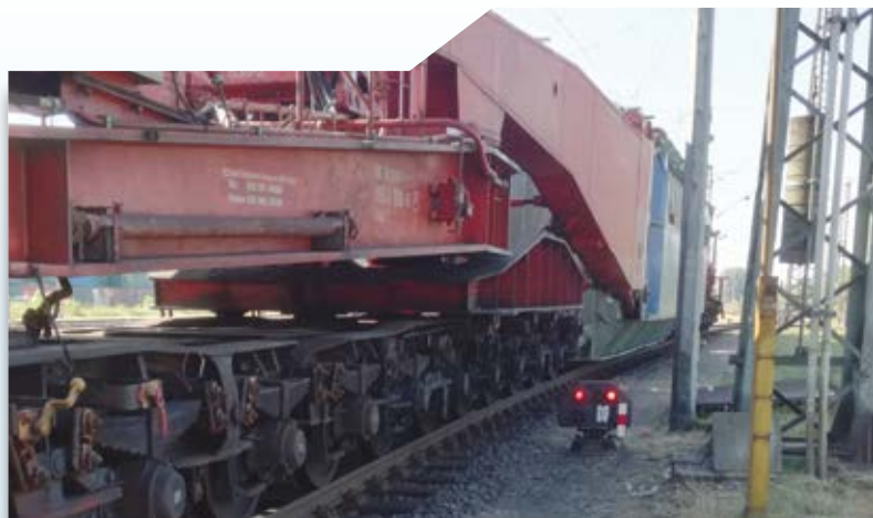
Millimeterarbeit am extra für diesen Transport herabgesetzten Lichtsignal und vorbei am Fahrleitungsmast.
